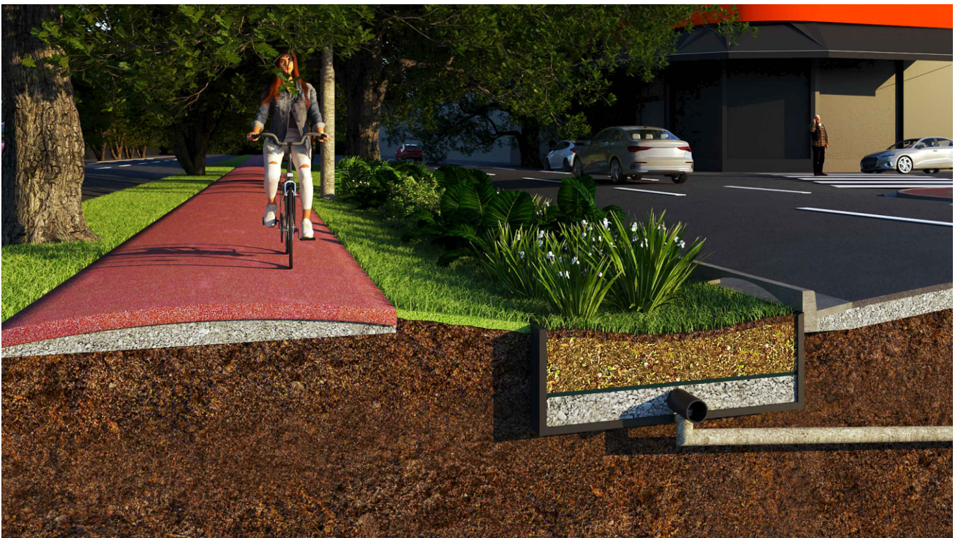
DETALHE - JARDIM DE CHUVA CANTEIRO CENTRAL AV. ANDRÔMEDA VISTA CICLOVIA
