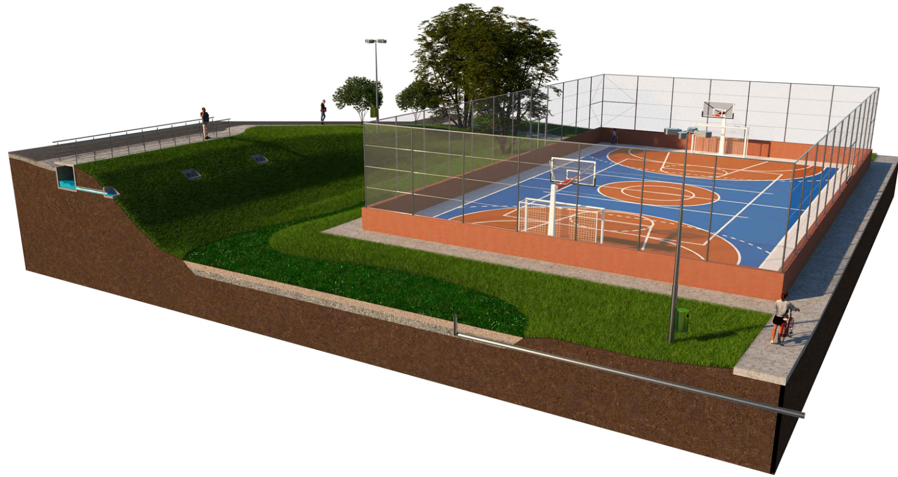
CORTE EM PERSPECTIVA - BACIA DE INFILTRAÇÃO VISTA AÉREA
