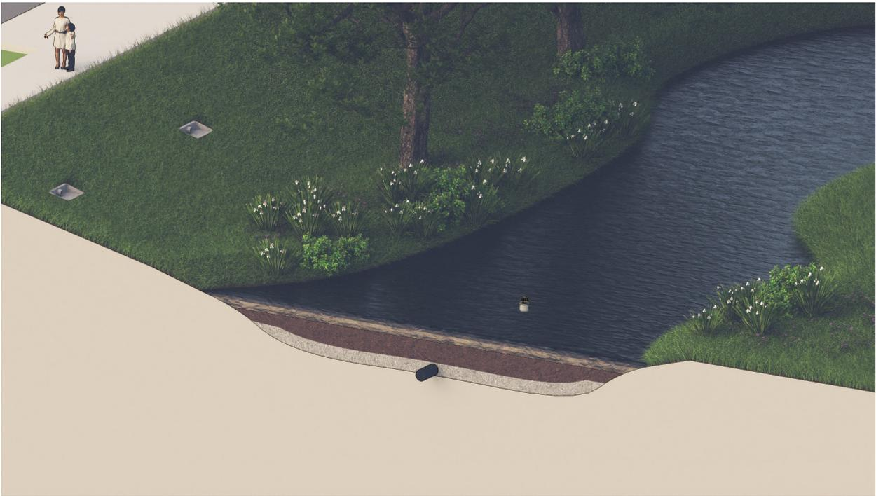
**FIGURA 28** Representação esquemática de retenção em lote aberto (FCTH, 2024)
