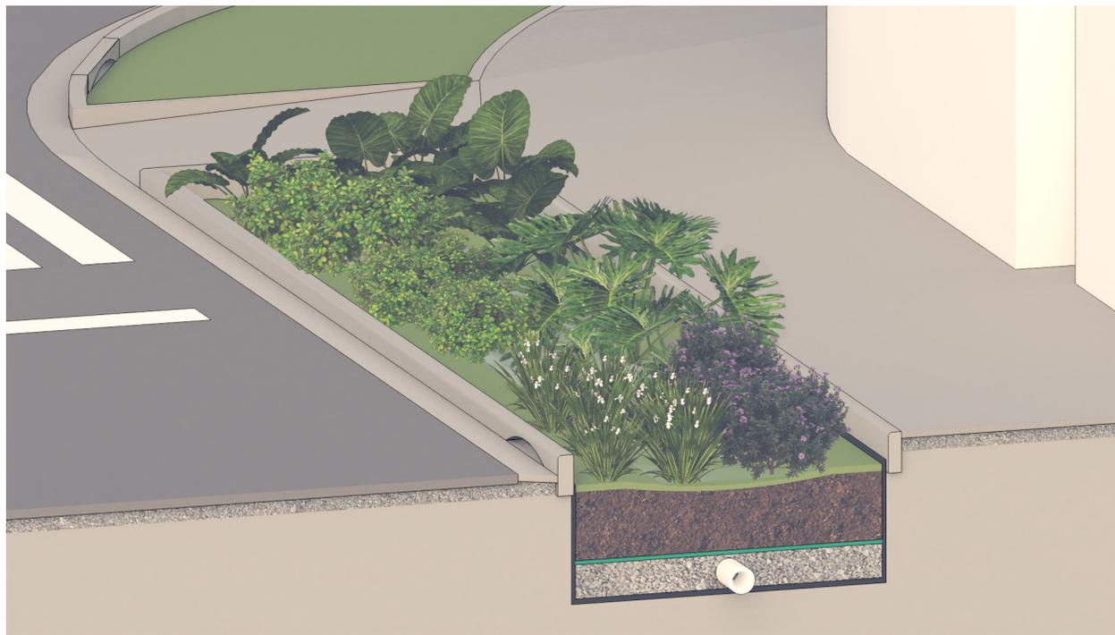
**FIGURA 19** Representação esquemática de jardim de chuva com sistema fechado (FCTH, 2024)
