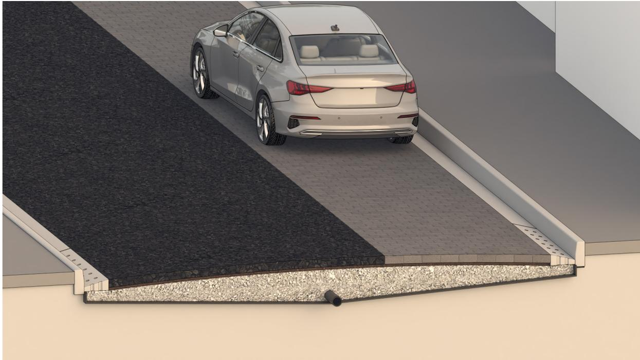
**FIGURA 24** Representação esquemática de pavimento permeável do tipo asfalto poroso (via à esquerda) e bloco de concreto (via à direita) (FCTH, 2024)
