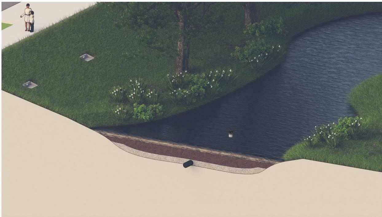
**FIGURA 25** Representação esquemática de bacia de retenção com cobertura vegetada (FCTH, 2024)
