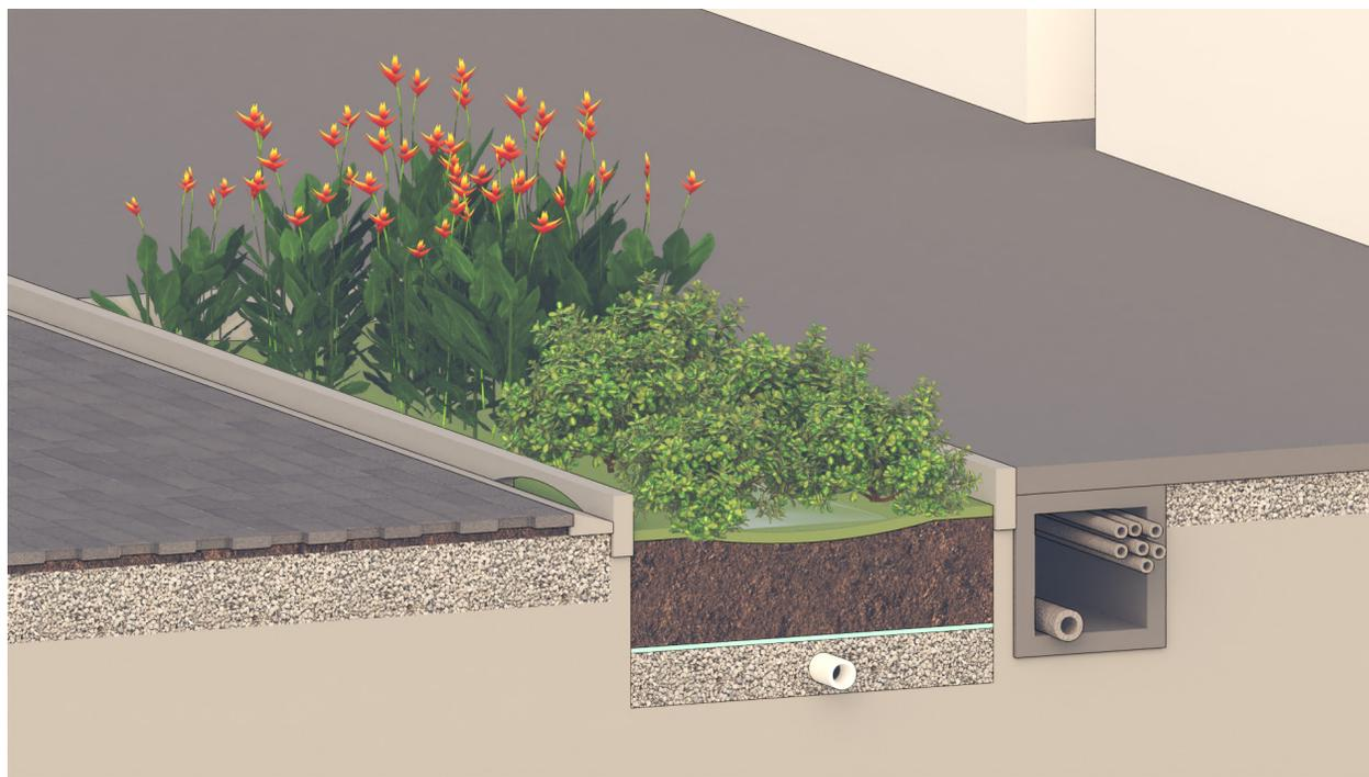
**FIGURA 20** Representação esquemática de jardim de chuva com sistema aberto (FCTH, 2024)
