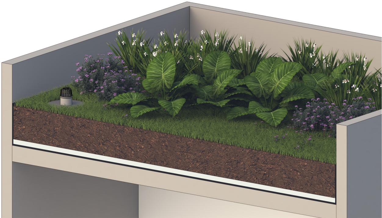
**FIGURA 23** Representação esquemática de telhado verde intensivo (FCTH, 2024)
