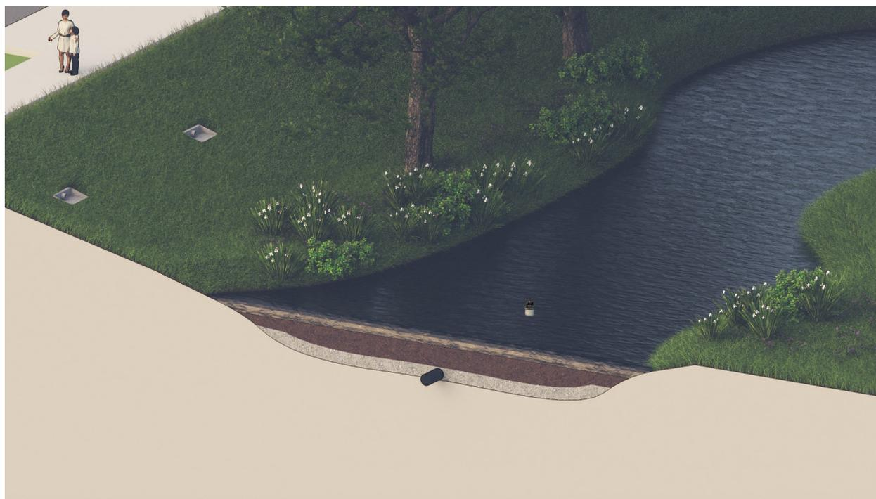
**FIGURA 27** Representação esquemática de trincheira de infiltração (FCTH, 2024)
