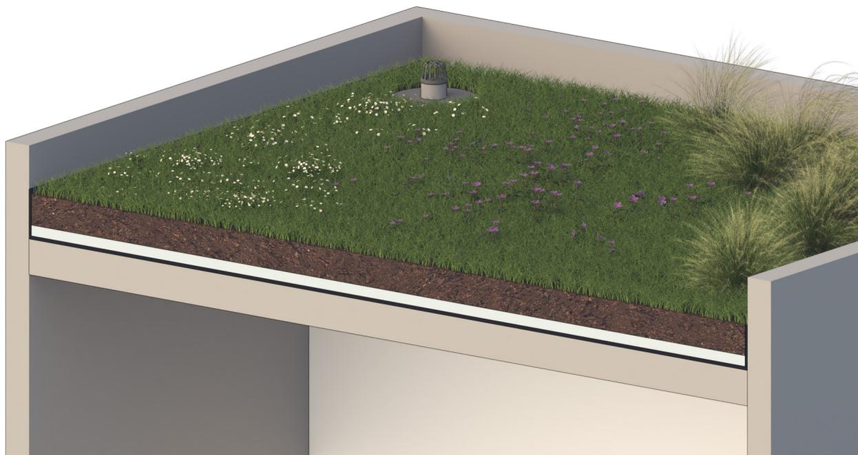
**FIGURA 22** Representação esquemática de telhado verde extensivo (FCTH, 2024)
