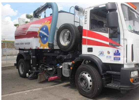
**Figura 30:** Caminhão varredeira mecanizada (Garizão)
